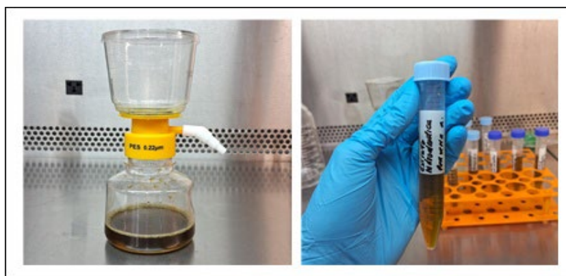
FIGURA 1: Filtração a vácuo do extrato hidroalcoólico de Petiveria alliacea .
