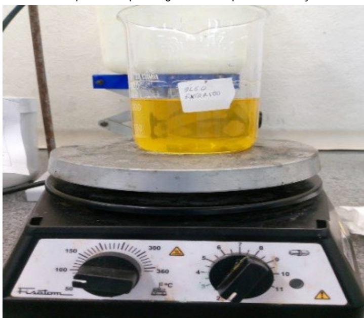
FIGURA 3: Esquema de aparelhagem utilizada para concentração do óleo.
